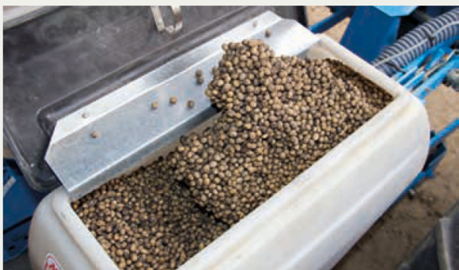
Insbesondere bei Impfmitteln mit Kleberzusatz sollte das Mittel am Saatgut antrocknen, bevor der Sätank befüllt wird.
