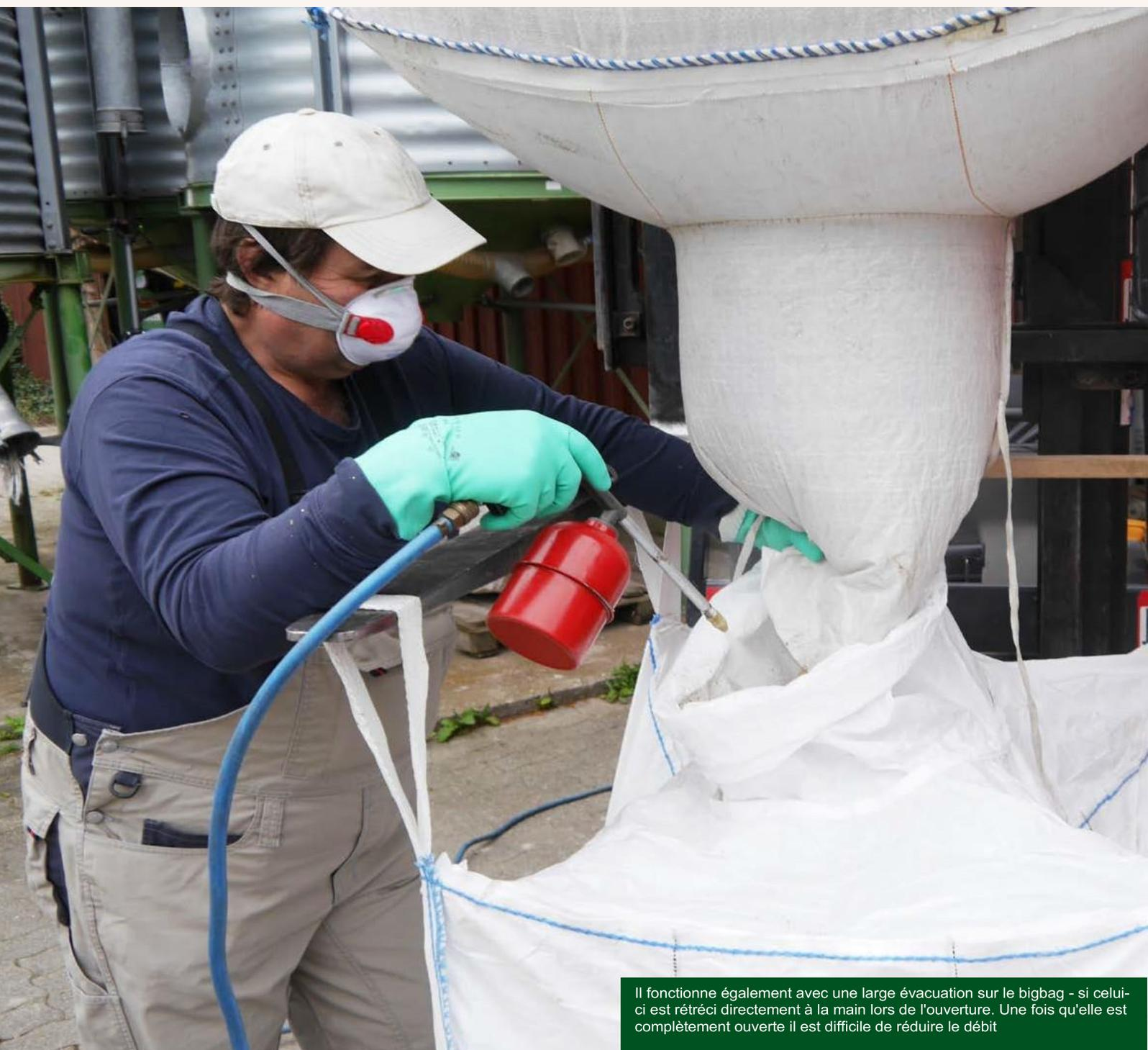
Il fonctionne également avec une large évacuation sur le bigbag - si celui-ci est rétréci directement à la main lors de l'ouverture. Une fois qu'elle est complètement ouverte il est difficile de réduire le débit
