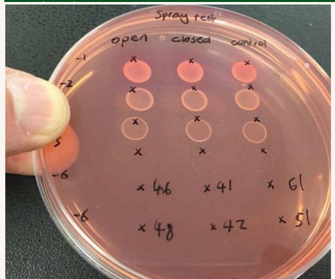
Le test effectué dans le laboratoire de notre fabricant d'inoculum a montré si la buse était grande ouverte, les bactéries des nodosités restent largement indemnes.
