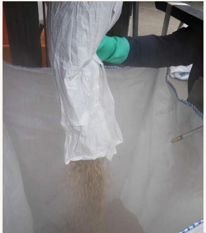
Rétrécissez légèrement la sortie du bigbag pour réduire le débit. Autrement plusieurs passages inutiles peuvent être nécessaire pour l'application de l'ensemble d'inoculum
