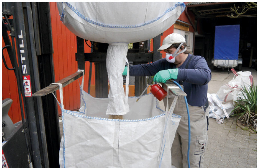
Sehr effizient bei großen Saatgutmengen: die Flüssig-Impfung mit Kompressor und Sprüh-pistole. Foto: Taifun Tofu GmbH
